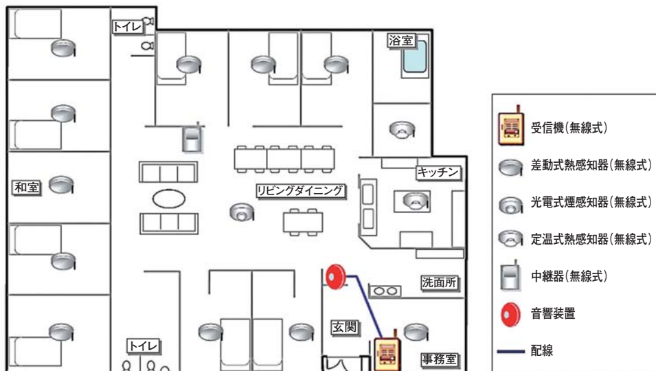
自動火災報知設備の感知器、中継器、受信機間のすべてを無線式にした例
